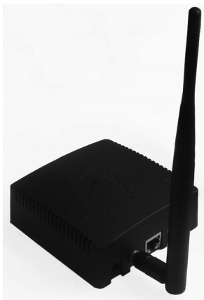
Rys. 7. Wandboard Quad w obudowie z zewnętrzną anteną Wi-Fi/Bluetooth
