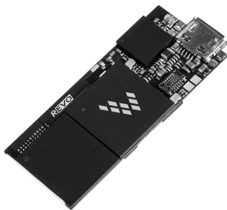
Rys. 13. Referencyjna platforma – miniaturowe urządzenie przenośne z procesorem i.MX6 SoloLite. Źródło: materiały prasowe
