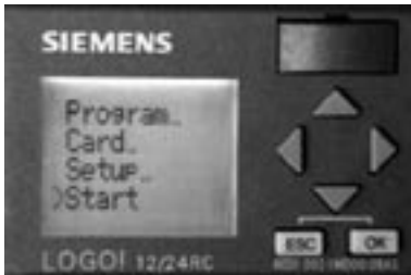
Rys. 1.19. Edycja programu dobiegła końca. Teraz trzeba wrócić do menu głównego programu. Wciskamy dwa razy ESC. Po dojściu do menu głównego programu naciskamy kilka razy przycisk w dół tak, aby kursor ustawił się na pozycji „Start”. Po wciśnięciu OK program jest już uruchomiony
