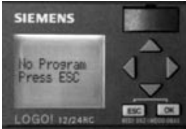
Rys. 1.11. Po podłączeniu sterownika do zasilania na wyświetlaczu widoczny jest napis: „No Program Press ESC”. Należy wcisnąć ESC, aby przejść do menu głównego sterownika
