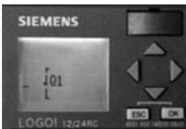
Rys. 1.15. Edycję programu z klawiatury sterownika LOGO! zawsze rozpoczyna się od wyjścia i prowadzi w kierunku wejść. Naciskamy OK
