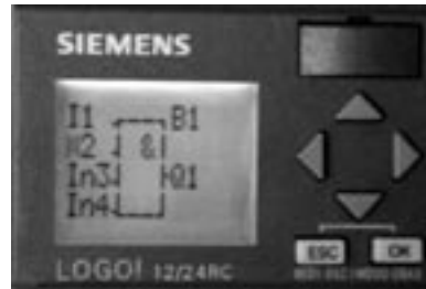
Rys. 1.18. Edycja wejścia IN2 wygląda dokładnie tak samo jak IN1. Wpierw należy nacisnąć dwa razy pod rząd OK. Gdy pojawi się symbol I1, naciskamy kursor w dół. W ten sposób wybieramy wejście I2 i wciskamy OK
