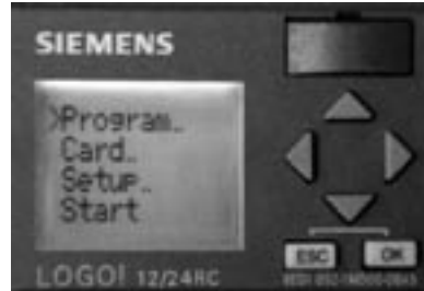
Rys. 1.12. Po wciśnięciu ESC pojawia się menu główne. Kursor ustawiony jest domyślnie na pozycji „Program...”. Należy nacisnąć OK
