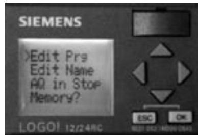
Rys. 1.14. Wciskając OK, wybieramy opcję „Edit Prg” z menu edycji programu
