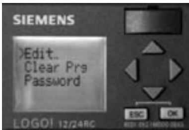
Rys. 1.13. Teraz na wyświetlaczu widoczne jest menu obsługi zapisanego w pamięci LOGO! programu. Kursor ustawiony jest na pierwszej pozycji „Edit...”. Wystarczy nacisnąć OK, aby przejść do edycji programu
