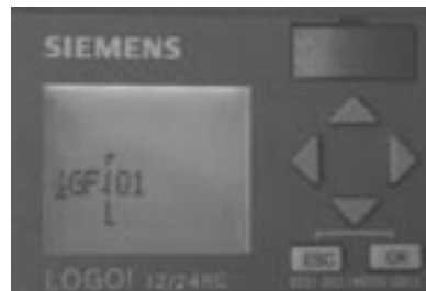
Rys. 1.16. Do wyjścia Q1 ma być podłączone wyjście funkcji AND. Funkcja ta należy do grupy funkcji o nazwie GF (general function). Wciskamy strzałkę kursora w dół, a następnie OK
