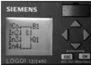
Rys. 1.17. Na ekranie pojawia się blok funkcji AND (iloczyn jest pierwszą funkcją w grupie GF). Wciskamy OK. Teraz przechodzimy do edycji wejść funkcji AND. Po wciśnięciu OK zamiast IN1 pojawia się napis Co. Jeszcze raz wciskamy OK. Na ekranie wyświetla się symbol wejścia I1, potwierdzamy go, naciskając OK
