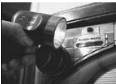
W systemie zdalnego sterowania Flashmatic wykorzystano cztery czujniki światła umieszczone w rogach obudowy telewizora
