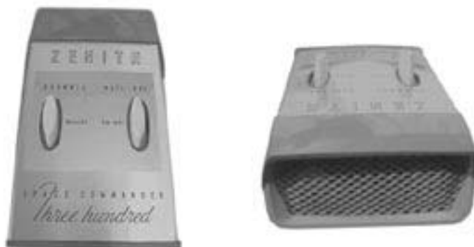
Nadajnik ultradźwiękowy Space Commander 300, który umożliwia wystanie dwóch poleceń: zmiany kanału i wyłączenia odbiornika
