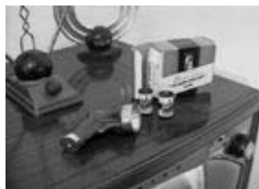
Integralnym elementem systemu zdalnego sterowania Flashmatic była specjalna latarka spełniająca rolę „pilota”
